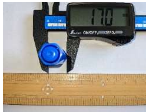
ノギスともものさしの測定精度の違い。(写真は教員用デジタルノギス)
